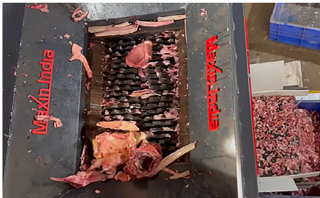
Kuva 3. Maxin India Machine Manufacturersin valmistama luiden murskauslaite (Maxin India Machinery Manufacturers Private Limited 2023)
