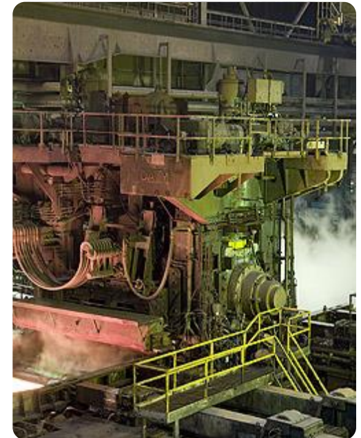
Suorakarkaisussa teräs jäähdytetään noin 900 °C asteesta huoneen lämpötilaan välittömästi valssauksen jälkeen. Näin saavutetaan erittäin kova martensiittinen mikrorakenne
