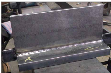
Kuva 10. Läpihitsatun T-liitoksen koekappale.
