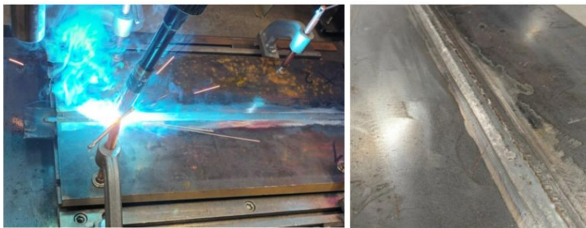
Kuva 3 Näytteiden hitsausta mekaanisella hitsausradalla Lapin AMK:n Älypajassa
