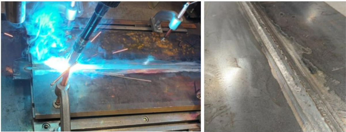
Kuva4 Froniuksen TP3200 CrNi 320A koneella ja mekaanisella hitsausradalla suoritettu hitsi
