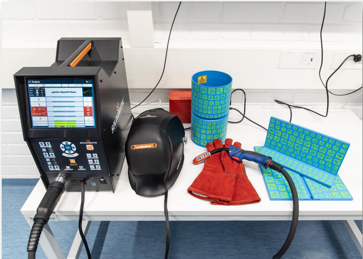
Kuva 1. Soldamatic-hitsaussimulaattori oheislaitteineen. Kuva Marjo Ollila
