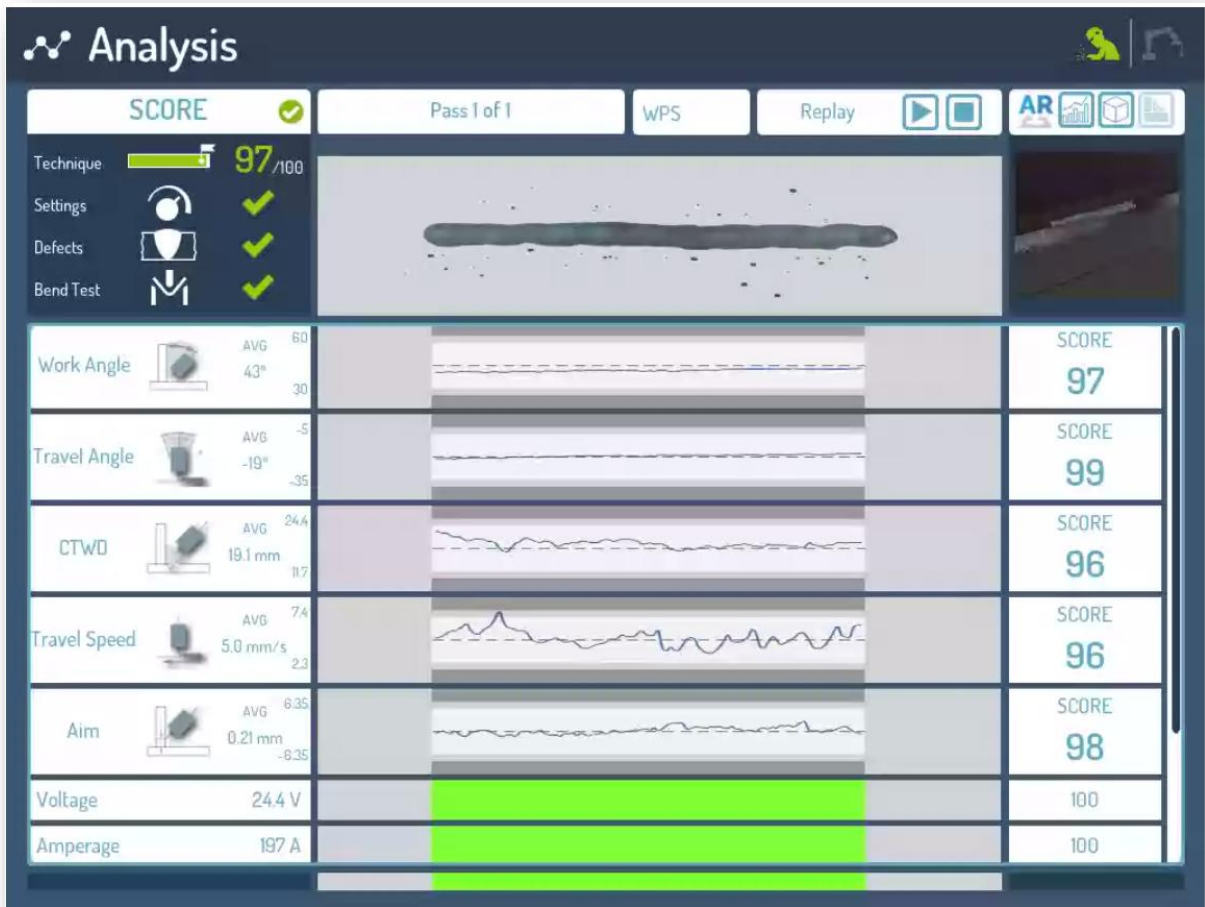
Kuva 3. Esimerkkikuva hitsausharjoituksen tekniikkaparametrien tuloksista. Harjoituksen kokonaispistemäärä on 97/100, tekniikkaparametrien tulokset ovat 96-99/100 ja kaikki kolme analysoitua kohdetta olivat hyväksytyjä.
