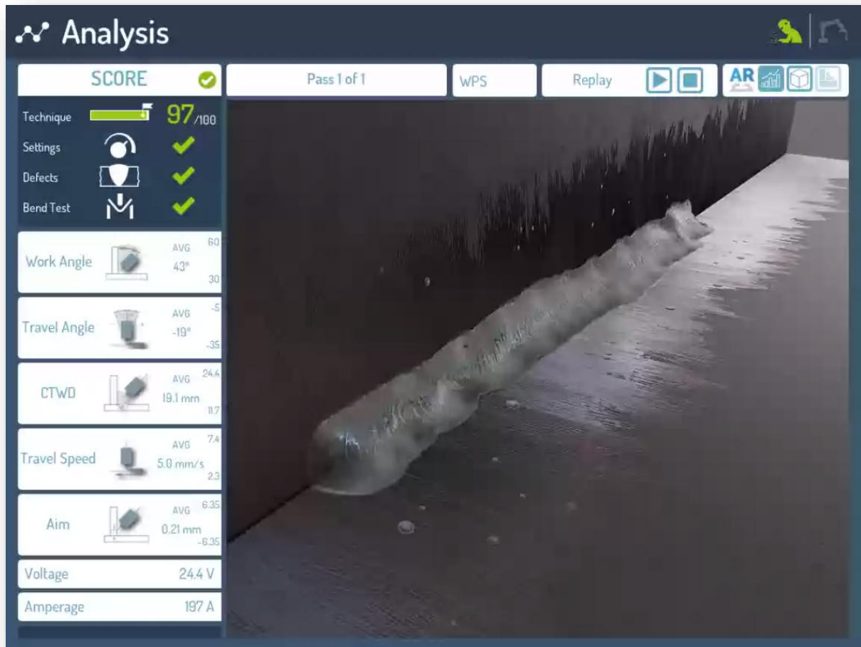
Kuva 4. Esimerkkikuva hitsin 3D-näkymästä. Näkymää voi kääntää ja pyöritellä haluamaansa kulmaan.
